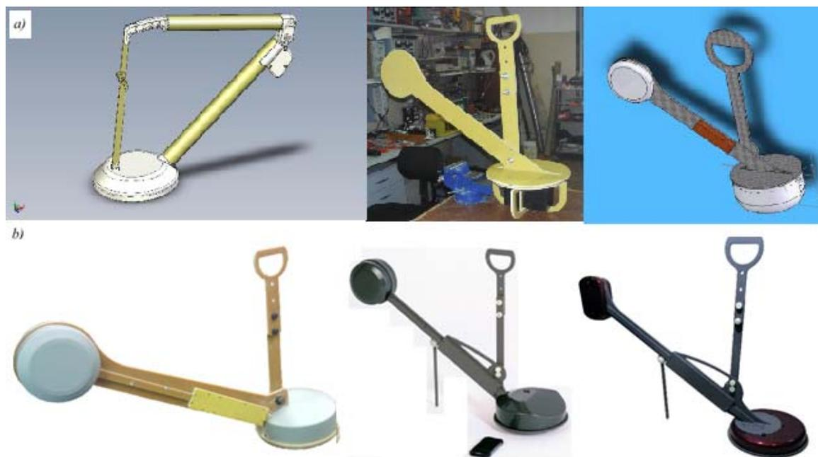
Рис. 3. Макет аппаратуры электромагнитного профилирования (а).
