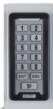
Рис. 2. Внешний вид кодонаборной панели Fig. 2. Appearance of the code dialing panel
