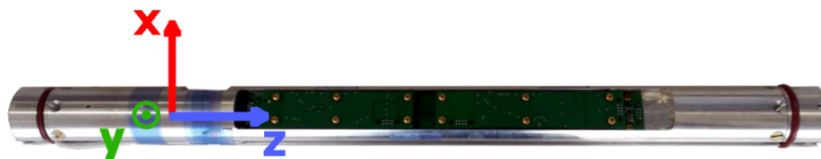
Рис. 1. Инклинометр производства НПП ГА «Луч» и система координат прибора Fig. 1. Inclinometer produced by NPP GA Luch and the coordinate system of the device
