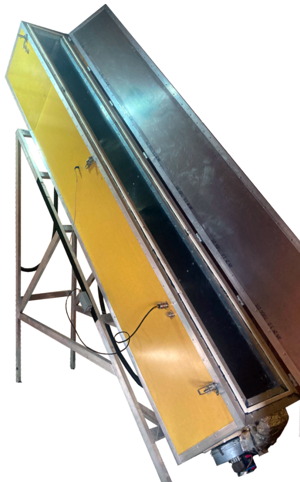
Рис. 3. Наклонная печь для проведения термоиспытаний, изготовлена из немагнитных материалов
