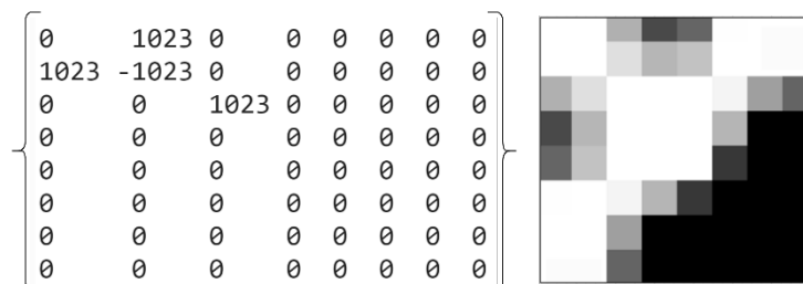
Рис. 7. Искусственно созданный DCT-блок (слева) и соответствующий ему блок пикселей (справа), который будет включен в финальное изображение-подпись
