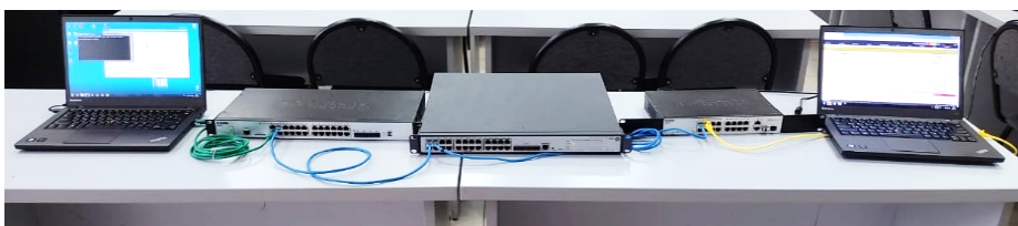
Рис. 5. Макет локальной СС СН Fig. 5. Layout of a special-purpose local communications network
