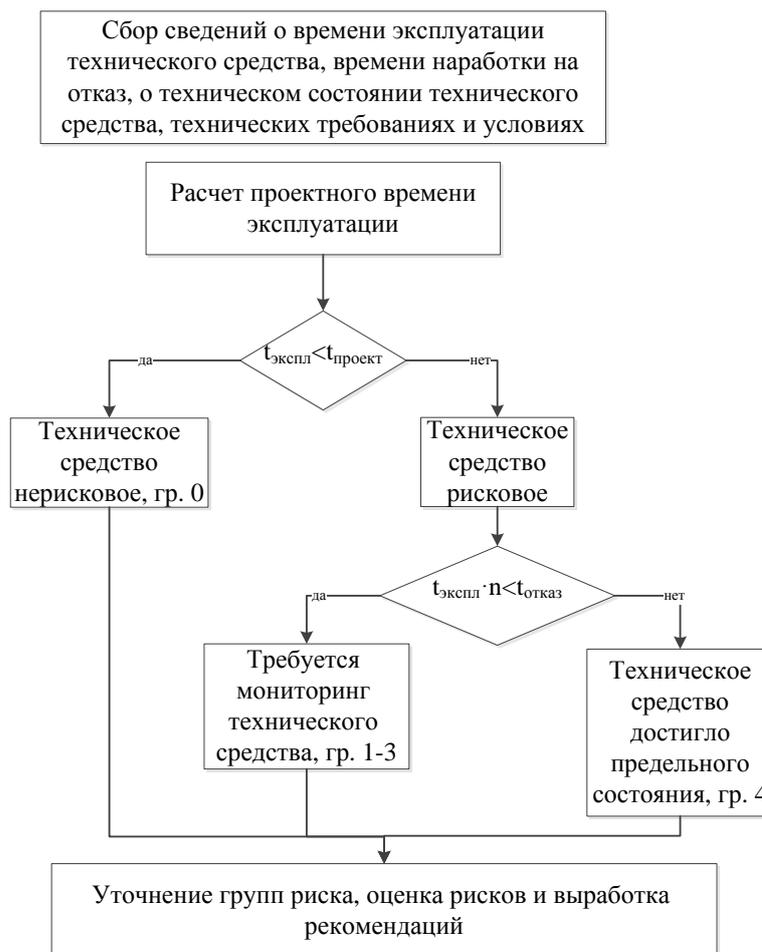
Рис. 2. Алгоритм идентификации рисковых технических средств
