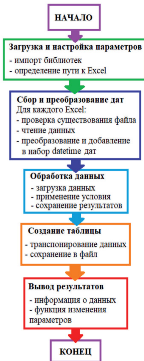
Рис. 9. Блок-схема программного инструментария и пользовательского интерфейса Fig. 9. Flowchart of software tools and user interface
