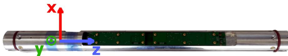
Рис. 1. Инклинометр производства НПП ГА «Луч» и система координат прибора
