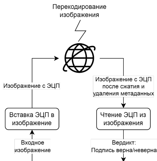
Рис. 1. Ожидаемая схема работы цифровой подписи Fig. 1. Scheme of expected digital signature method
