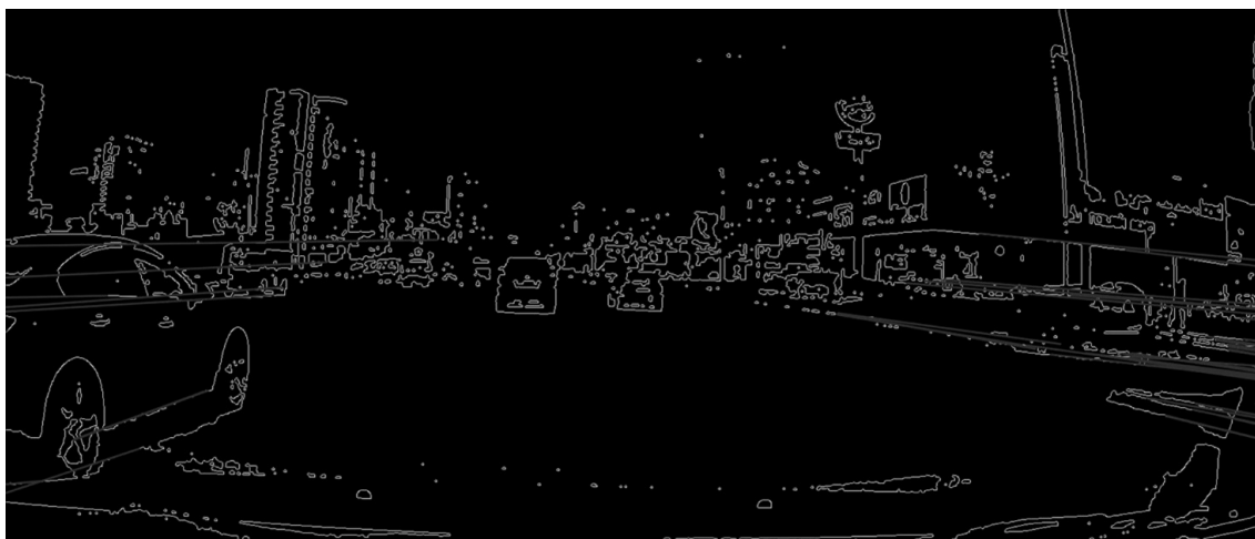
Рис. 3. Результат работы модуля определения границ полосы Fig. 3. The result of the module for determining the lane boundaries
