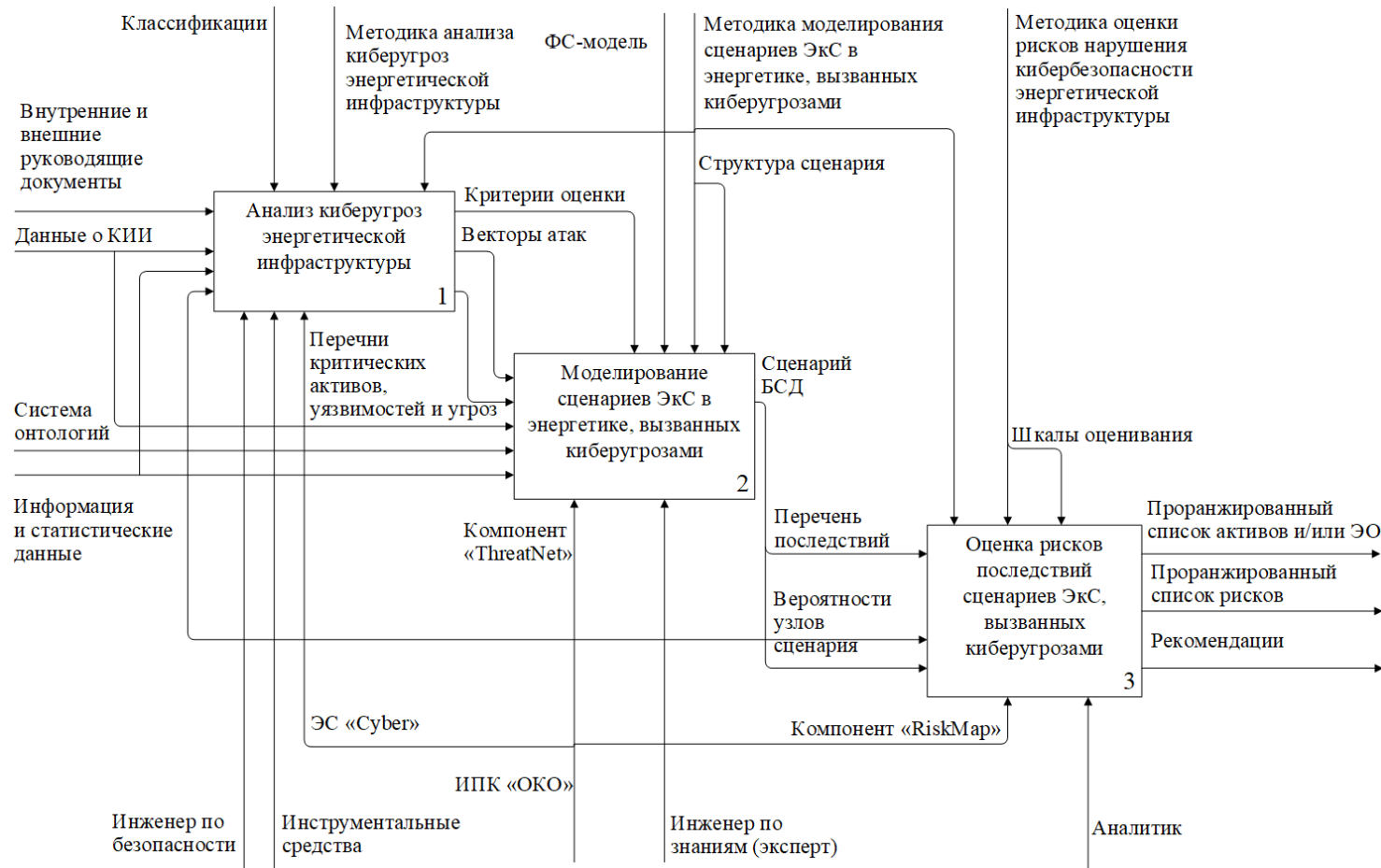
Рис. 2. Декомпозиция первого уровня анализа киберситуационной осведомленности об энергетических объектах в нотации IDEF0 Fig. 2. First level decomposition diagram of the cyber situational awareness analysis of energy facilities in IDEF0 notation
