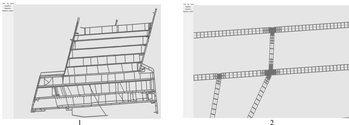
Рис. 12. Внешний вид приложения с загруженной сетью горных выработок шахты «Котинская» АО «СУЭК-Кузбасс»: 1 – общий вид; 2 – участок шахты с детализированной разностной сеткой
